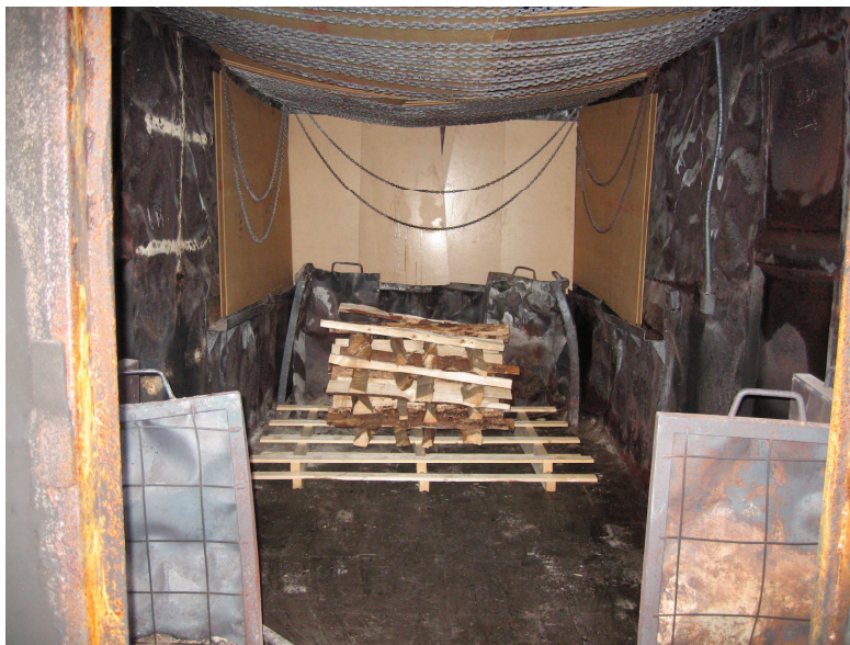
Obr. 27 - Rozmístění paliva v Backdraft kontejneru [30]
