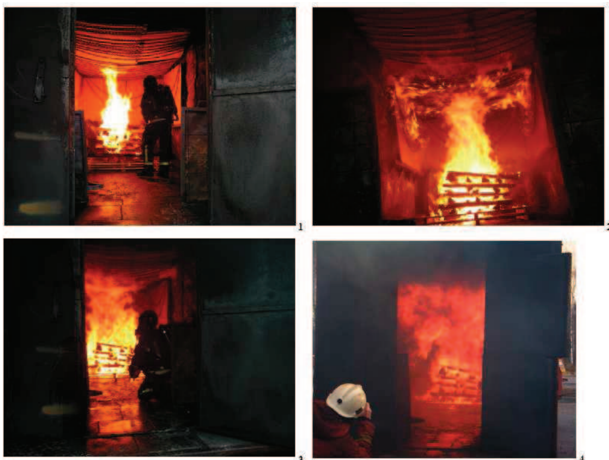
Obr. 28 - Rozvoj požáru v Backdraft kontejneru [30]
