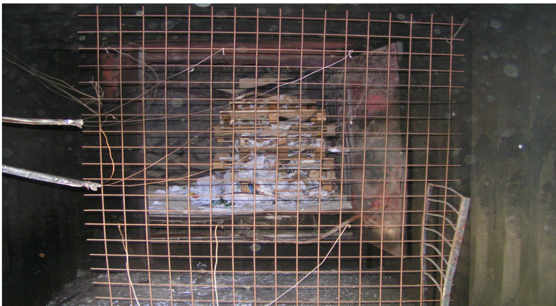
Obrázek 20: Umístění první sítě a rozmístění termočlánků
